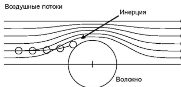
При резком изменении воздушного потока, частичка с достаточной величиной инертности перестает следовать за воздушным потоком и ударяется в волокно. Инертность аэрозольной частички зависит от ее размера, плотности, конфигурации и скорости движения. Тяжело груженный грузовик мчится к препятствию с очень большой скоростью. Сила инерции заставит грузовик удариться о препятствие. В то же время легковые автомобили без труда обходят препятствие.
