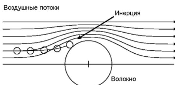
При резком изменении воздушного потока, частичка с достаточной величиной инертиности перестает следовать за воздушным потоком и ударяется в волокно. Инертность аэрозольной частички зависит от ее размера, плотности, конфигурации и скорости движения. Тяжело груженый грузовик мчится к препятствию с очень большой скоростью. Сила инерции заставит грузовик удариться о препятствие. В то же время легковые автомобили без труда обходят препятствие.
