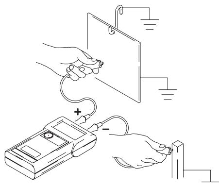
При распылении краски на заземленные предметы сопротивление должно быть  $< 1$  мегома. Подвески для деталей должны быть чистыми и заземленными.
