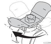
Закройте клапан подачи воздуха к источнику жидкости и на пистолет.
