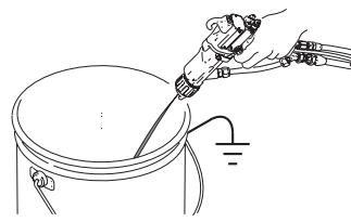
Нажмите курок и направьте пистолет в заземленную металлическую емкость.
