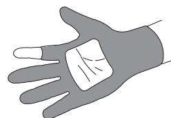
Токопроводящие перчатки поставляются вместе с пистолетом. Однако, если перчатки не компании Graco износились, отрежьте пальцы на перчатках или вырежьте участок перчатки на ладони для обеспечения контакта руки с заземленной ручкой пистолета.
