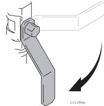
Откройте клапан слива жидкости. Используйте емкость для сбора сливаемой жидкости. Оставьте клапан открытым до момента готовности к распылению.
