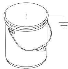
Заземлите все емкости с жидкостями и емкости с отходами, а также все другие токопроводящие предметы, находящиеся в зоне распыления. Не используйте пластиковые емкости.
