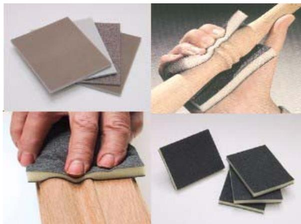
Шлифовальный материал на поролоне для шлифования плоскостей, средних и сложных профилей и контуров, кромок и других элементов из древесины, пластика и металла, а также лакокрасочных покрытий. Шлифовальные маты более гибкие, чем шлифовальные губки, поскольку абразивный материал нанесен с двух или с одной стороны.
