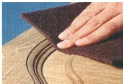
Нетканные шлифовальные материалы широко используются для удаления заусенец и деликатного шлифования деревянных поверхностей и лакокрасочных покрытий, для удаления ржавчины, следов коррозии и затвердевших загрязнений на металлических поверхностях, а также для доводочных работ и полирования.
