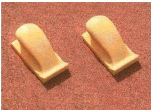
Односторонняя шлифовальная колодка на «липучке» с удобным контуром под ладонь из мягкого вспененного полиуретана для ручного шлифования с использованием шлифовальной бумаги в рулонах с перфорацией листов размером 70 x 125 мм значительно облегчает шлифования плоскостей и равномерно распределяет давление по шлифуемой поверхности, обеспечивая тем самым лучший оптический эффект шлифования.
