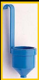
Существует более 50 способов определения вязкости. В настоящий момент мы больше не используем определение вязкости ЛКМ в сантипуазах (сps). Мы измеряем время (в секундах), за которое определенный объем ЛКМ вытекает из чашки снабженной отверстием определенного калибра. Измерение вязкости таким образом называется измерением с помощью вискозиметра.
