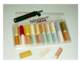
Для быстрой заделки повреждений и дефектов на ненагруженных деревянных или синтетических поверхностях используется *Мягкий воск НОВОРИТ*. Мягкий воск прост в применении, на повреждение мягкий воск наносится *Шпателем НОВОРИТ* или просто натирается поперек повреждения с одновременным уплотнением, излишки удаляются шпателем.
