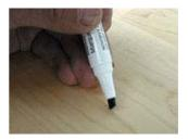
С помощью Ретуширующих фломастеров НОВОРИТ (вентильных или волокнистых) проводится восстановление текстуры и выравнивание цвета поверхности. Довольно часто восстановление цвета поверхности или предварительное ретуширование контура повреждения проводится чистой ветошью, слегка увлажненной ретуширующим составом. Ретуширующие фломастеры используются также для подкрашивания мебельных и оконных стыков и пазов.
