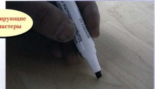
Для подкрашивания кромок и пазов (проводить сплошной линией), восстановления текстуры (заостренным стержнем) и выравнивания цвета поверхности (ветошью, увлажненной ретуширующим составом).
