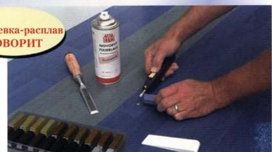
Для заделки повреждений и дефектов на нагруженных поверхностях. Наносится в расплавленном виде с помощью воскоплавителя (паяльника), после некоторого охлаждения удалить излишки шпателем или стамеской.
